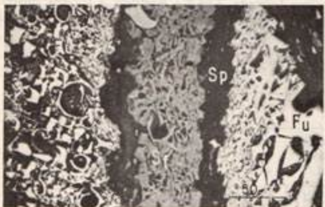
FOTOGRAFIA 6.— Esta imagen muestra una banda de semifusinita (Sp) en la parte central de la fotografía (color gris claro), rodeada por dos bandas de semifusinita (Fu). Muestra ED-1282 del Norte de Santander.
