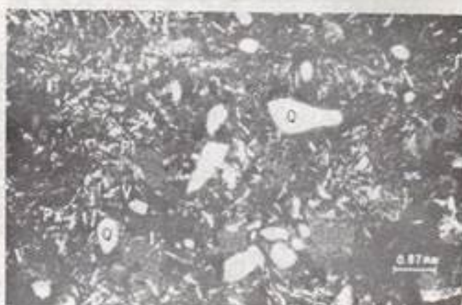
FIG. 8: Grado de Cristalización. Para-Lava basáltica contaminada por material sedimentario, cuarzo detrítico (Q). Cristales diminutos de plagioclasa (Pl), piroxeno (Px) y vidrio (V). Nícoles paralelos. Muestra EA - 40 A.
