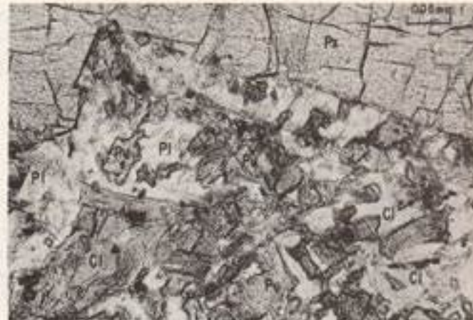
FOTO No. 2 - Metadiabasa. Contraste de relieve y tono. El relieve de la pumpellita (Pu) es semejante al de la augita (Px), el relieve de la albita (Pl) y clorita (Cl) es bajo.
