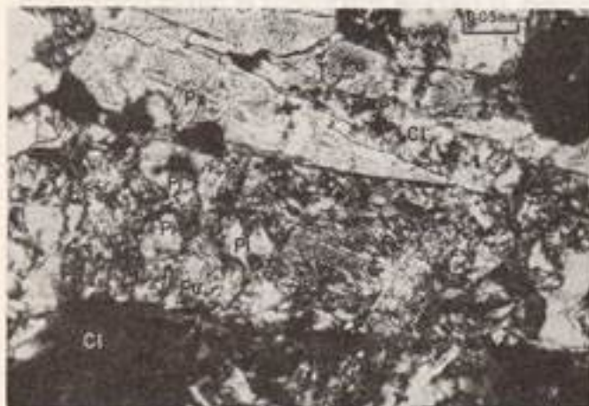
FOTO No. 3 - Metadiabasa. Seudomorfo de plagioclase pumpellitizada (Pu) con remanente de albita (Pl). Arriba se observa augita (Px), abajo clorita (Cl).
