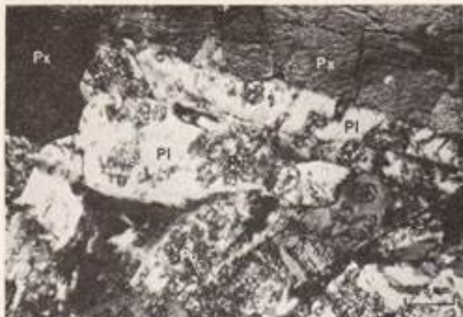
FOTO No. 1 - Metadiabasa con textura ofítica. Dos cristales de albita (Pl) con pumpellita (Pu) radial. Arriba Augita (Px) fresca.
